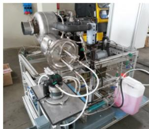
Progetto, realizzazione e test di un prototipo di combustore per microturbina per olio di pirolisi. Valutazioni tecnico-economiche su tre casi studio cogenerativi (RSA, piscina, piccola industria alimentare)
